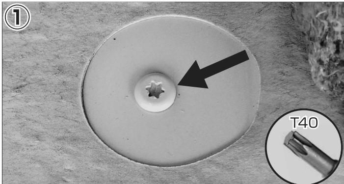
ステップ部の樹脂パーツを内装剥がし等で取り外します。
