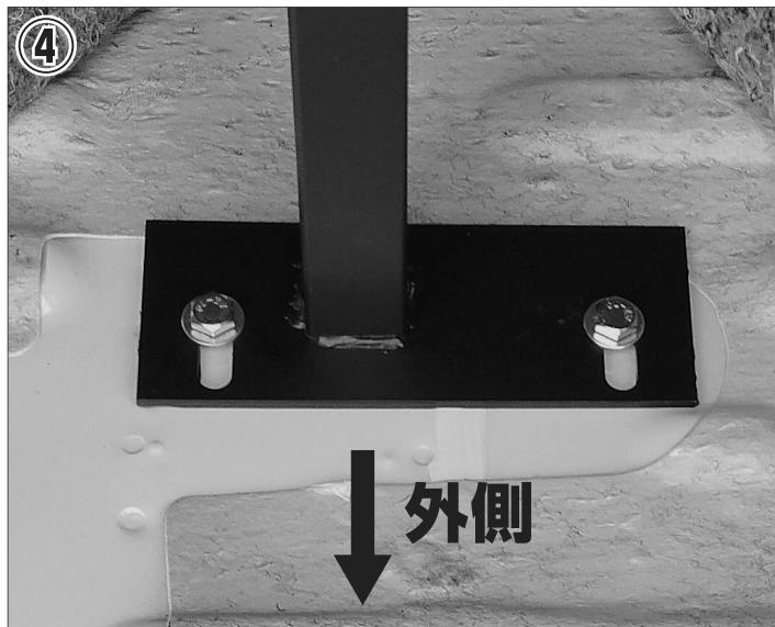
シート取付部のボルト穴を用いてベッド前部用脚を図の向きで純正ボルトを使用して仮締めで取り付けます。
