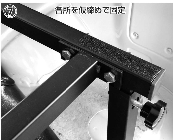
後部サイドバーのボルト・ナットに長穴をあわせて仮締めします。フレーム高さを一番低い段階に合わせてノブ付きM6ボルトで脚部をすべて仮締めします。
