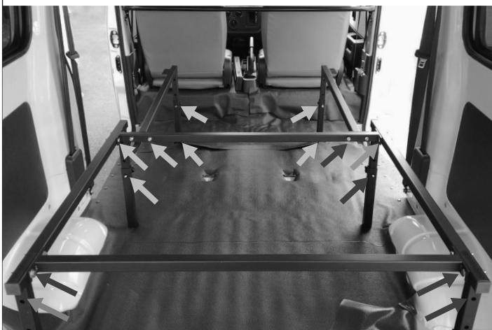
1列目2列目ベッドをセットし、ベッド状態やリクライニング状態にして各ボルトでの取付部分を本締めします。
