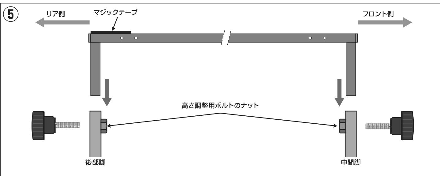
後部メインフレームの上面にマジックテープが付いている側に後部脚を、もう一方の脚部を中間脚に差し込みます。中間脚のナットの向きに注意して下さい。脚を差し込みましたら高さを一番低い位置でノブ付きM6ボルトで仮締めで固定します。※ノブ付きM6ボルトを斜めになっていた状態でねじ込むとネジ山やナットが破損する恐れがあります。
