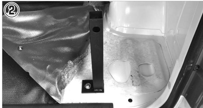
取り外したボルト穴にベッド後部用脚を図の向きで
