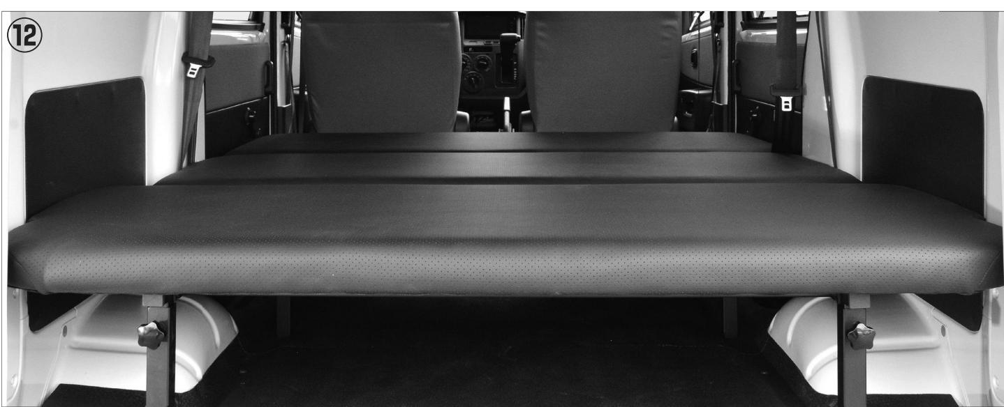
フレーム部、サイドバー部、ベッド取り付け部の本締めが完了したら3列目のベッドを取り付けて完成です。
