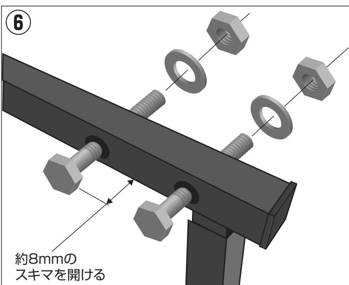
メインフレームの穴に図のようにM8x44ボルトとナット、ワッシャーをセットしてサイドバーを仮締めで組み立てます。
