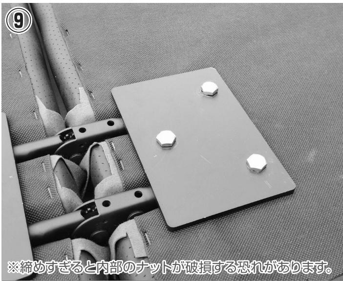
※締めすぎると内部のナットが破損する恐れがあります。
