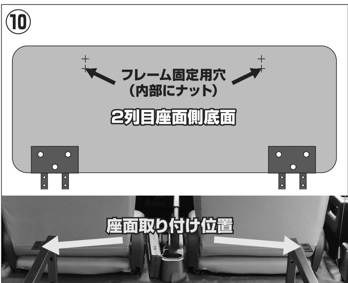
前部メインフレームのアングル部分にリクライニングラッチを取り付けたベッドの座面部の穴（底面に穴があります）に合わせてM8×44ボルトにて仮締めで取り付けて下さい。
