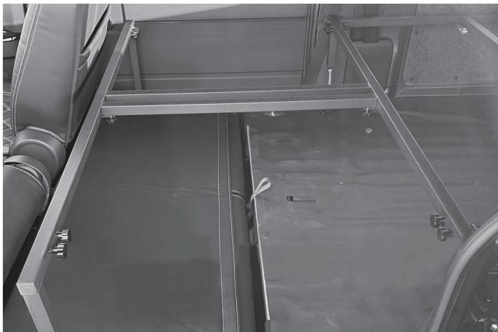
⑨ ベースフレーム前部とベースフレーム中部の外側をフロント接続用外側縦バー、側縦バーでつなぎます。
