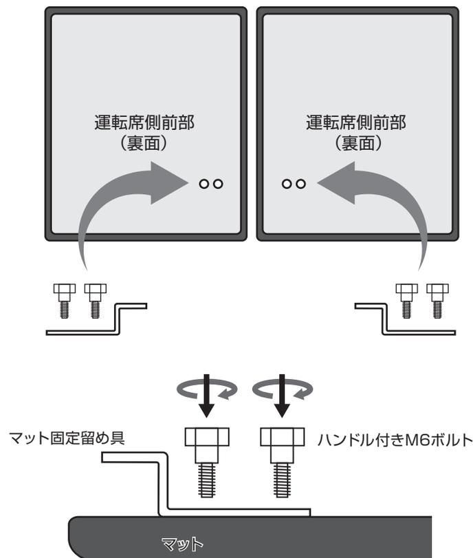
②ベッドマット前側を設置するときは、マット固定留め具がフロント用縦バーに引っ掛ける形で下図のように斜めからフロント用縦バーに差し込んで下さい。マット両端に荷重がかかった場合の跳ね上がり防止になります。
