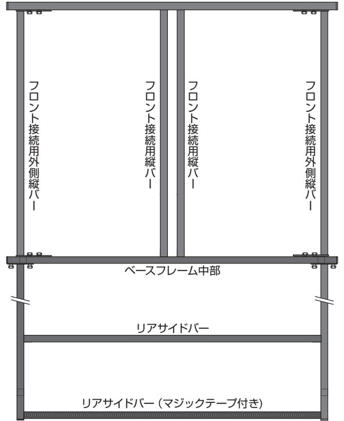
■ フロント接続用外側縦バーの取り付け方
