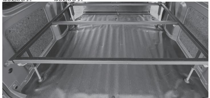
⑥ ベースフレーム前部のネジ穴に付属のM6ハンドル付きボルト4本を軽くねじ込んでおきます。脚部にM12アジャストボルトを締め入れて
