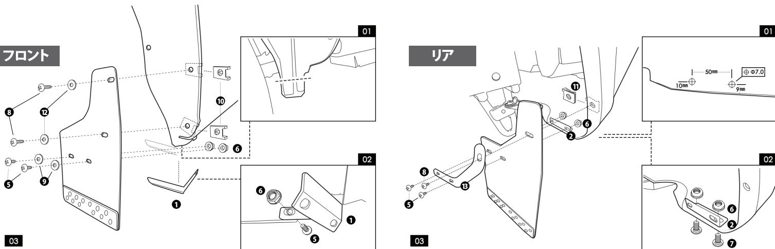
[フロント] ベルト吊りブラケットを取り付けます。 マッドガードのベルトをベルト吊りブラケットへ取り付けます。
