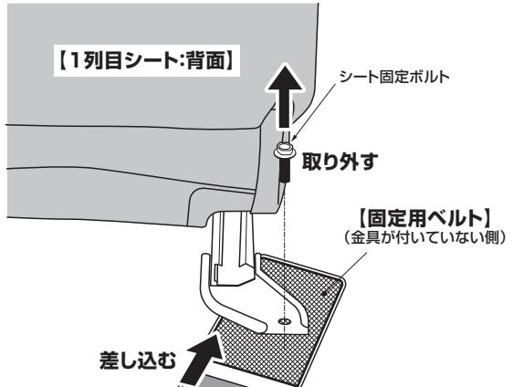
シート固定ボルトの外側各1本ずつを取り外します。 シートレール下に
