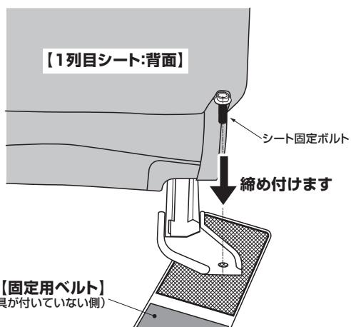
②で外したシート固定用ボルトを固定用ベルト(金具が付いていない側)と一緒に締め付けます。
