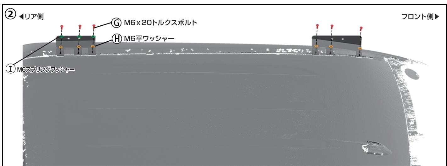
各ブラケットをM6x20トルクスボルト(G)と M6平ワッシャー(H)を用いて固定して下さい。
