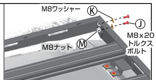
バックプレートの取り付け、バックプレート (C)をサイドプレートの穴に合わせ、M8x20トルクスボルト (J)
