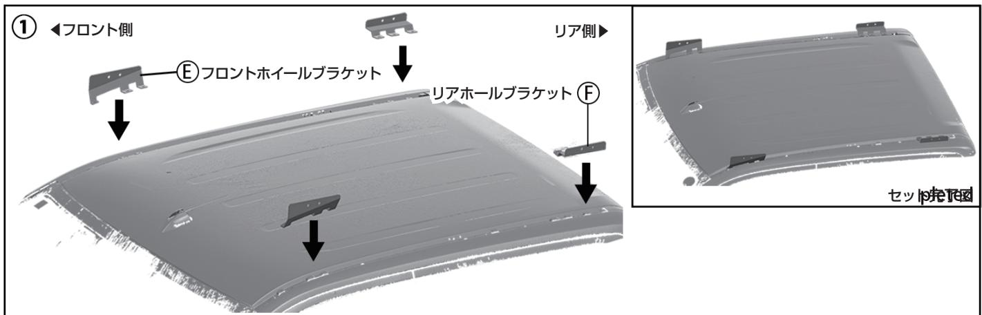
フロントとリアのホールブラケット (E,F)をルーフにミゾ部分にセットして、サイドプレートの取り付け位置に合わせます。
