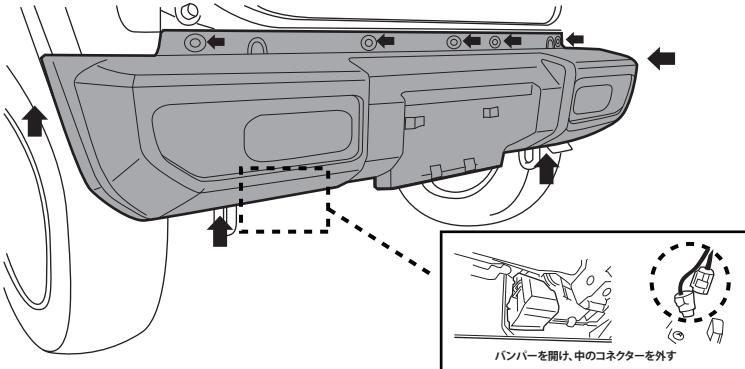
**STEP 01** 矢印箇所のクリップ、ネジ類を外し、バンパーを外します。
