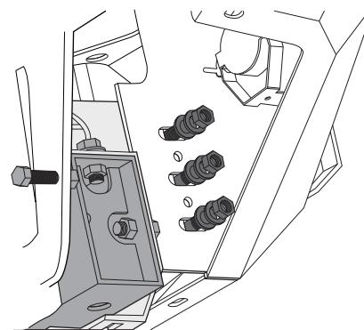
**STEP 04** M12ボルトを締め付けて、ブルバーを車体に取り付けます。両側とも同じように行ってください。
