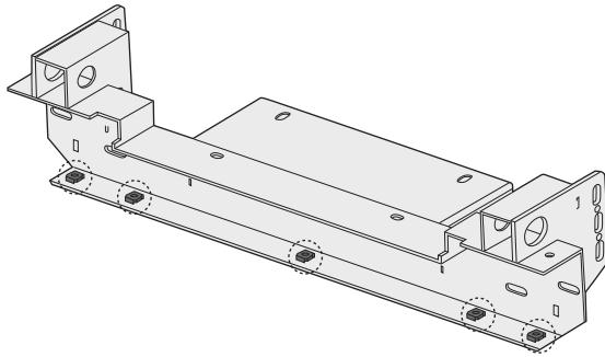
STEP 01 クリップナットM8(4mm)をワインチベースに取り付ける準備をします
