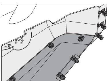
**STEP 07** トラスヘッドネジを締めてマッドガードをブルバーに取り付けます。
